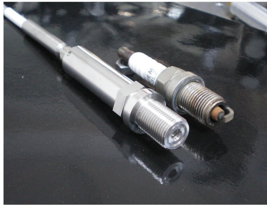
Fig. 2 Dispozitivul laser de tip bujie (stanga), cu dimensiuni comparabile cu cele ale unei bujii clasice (dreapta).
