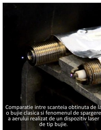
Fig. 6 Comparatie intre scanteia produsa de laser (prin 'spargerea' aerului) si ce produsa de o bujie clasica
