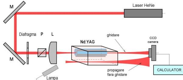
Fig. 6 Montaj experimental utilizat pentru caracterizarea ghidurilor de unda. M: oglinda; P: polarizor; L: lentila
