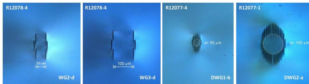
Fig. 9 Exemple de ghiduri de unda realizate in diferite medii Nd:YAG ceramice: Ghiduri de tip 'doi pereti', cu distantele intre linii de 50 si 100  $\mu\text{m}$ , precum si ghiduri de unda ,ingropate' de tip circular, cu diametrele de 50 si 100  $\mu\text{m}$ .
