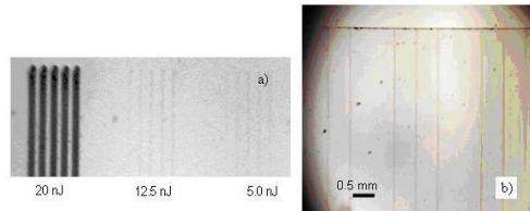
Fig. 2 a) Imagine de microscop a unei probe de sticlă iradiate cu laserul fs la diferite energii ale pulsului laser. b) Structuri realizate în volumul sticlei.
