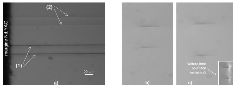
**Fig. 4 a)** Inscriptionari realizate cu obiectivul 100x la suprafata mediului Nd:YAG (1) si la o distanta de 2  $\mu\text{m}$  sub suprafata mediului (2). Trase realizate cu obiectivul 20x la adancimi de **b)** 250 si **c)** 300  $\mu\text{m}$ .
