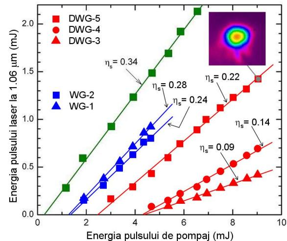
Fig. 8 Energia pulsului laser la 1.06  $\mu\text{m}$  in functie de energia pulsului de pompaj la 808 nm pentru diferite ghiduri de unda. Este prezentata si o distributie (2D) a fascicolului laser obtinut de la ghidul de unda DWG-5.
