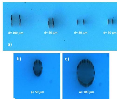
Fig. 12 Ghiduri de unda de tip a) 'doi pereti' si de tip circular cu diametrul de b) 50  $\mu\text{m}$  si c) 100  $\mu\text{m}$  realizeate in Nd:YVO<sub>4</sub>.
