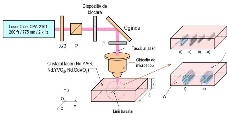
**Fig. 3** Montajul experimental folosit pentru scrierea ghidurilor de unda in mediile laser Nd:YAG, Nd:YVO<sub>4</sub> si Nd:GdVO<sub>4</sub>.
