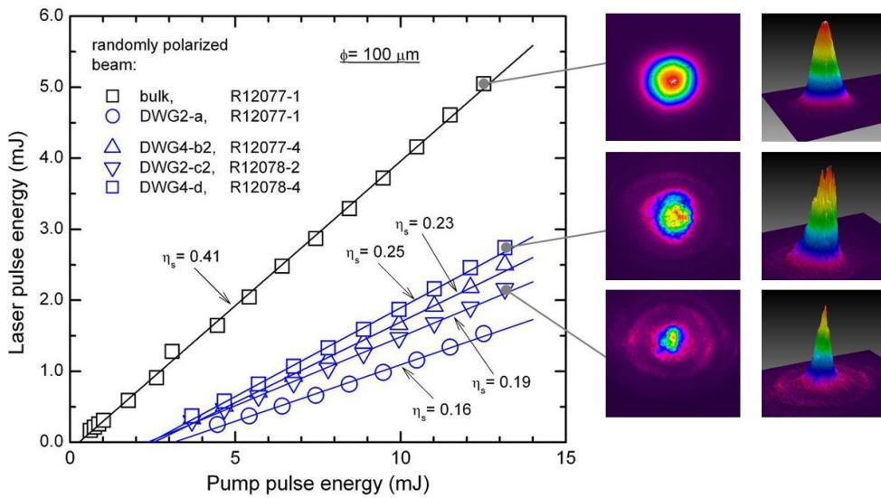
**Fig. 10** Energia pulsului laser la 1.06  $\mu\text{m}$  in functie de energia pulsului de pompaj la 807 nm pentru ghidurile de unda 'ingropate' cu diametru de 100 mm realizate in mediile laser Nd:YAG ceramice. Sunt prezentate (in dreapta) si distributiile 2D si 3D, in camp apropiat, ale fasciculelor laser.
