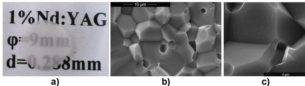
Fig. 9 a) Fotografie a unui mediu Nd:YAG ceramic obtinut prin tehnici ceramice. Imagini SEM ale granulelor monocristaline la scara de: b) 10  $\mu\text{m}$  si c) 4  $\mu\text{m}$ .
