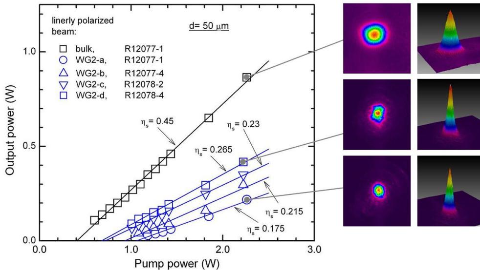
**Fig. 11** Puterea fasciculului laser la 1.06  $\mu\text{m}$  in functie de puterea de pompaj incidenta pe mediile Nd:YAG ceramics, pentru ghidurile de unda de tip 'doi pereti' cu distanta intre linii de 50  $\mu\text{m}$ . Sunt ilustrate si distributiile 2D si 3D, in camp apropiat, ale fasciculelor laser.
