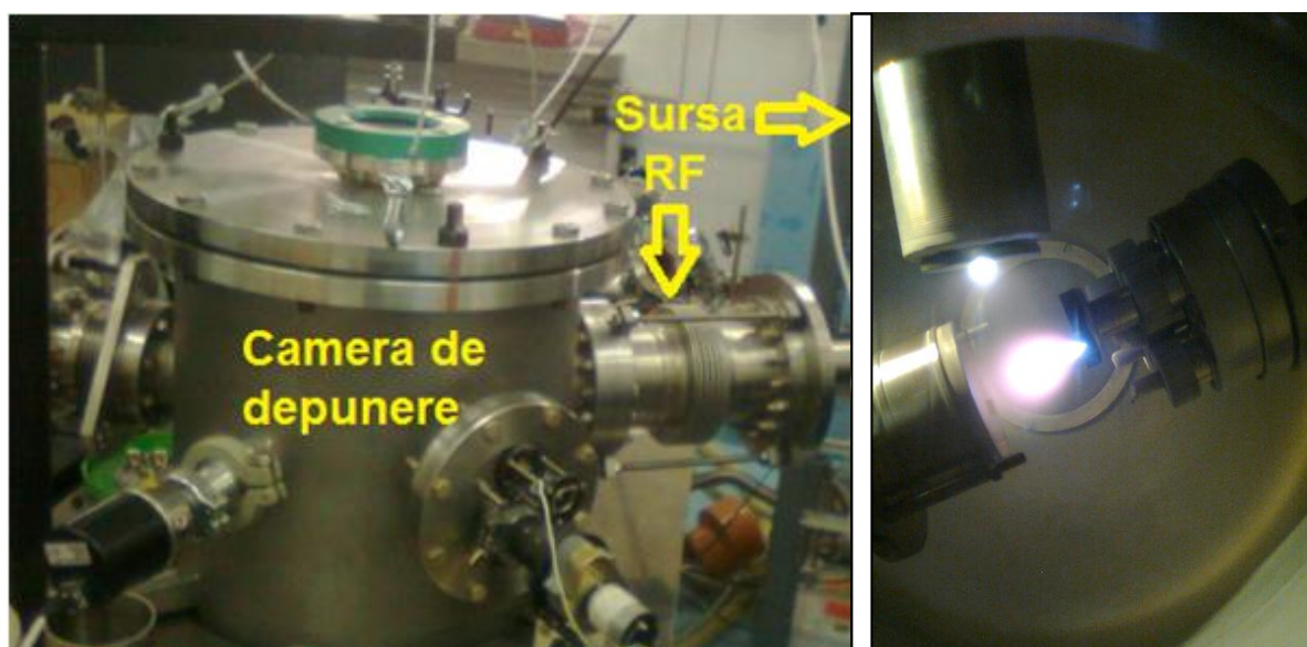
Figura 2.6: Imagine de ansamblu a incintei de depunere PLD la care a fost adaptată sursa de RF. [167]
