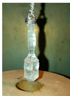
Figura 2.6. Cristal LGSB crescut folosind al doilea montaj termic, pornind de la o compoziție a topiturii \text{La}_{0.678}\text{Gd}_{0.572}\text{Sc}_{0.75}(\text{BO}_3)_4 .
