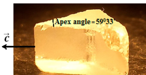
Figura 2.10. Prisma tăiată și orientată din cristalul LGSB.
