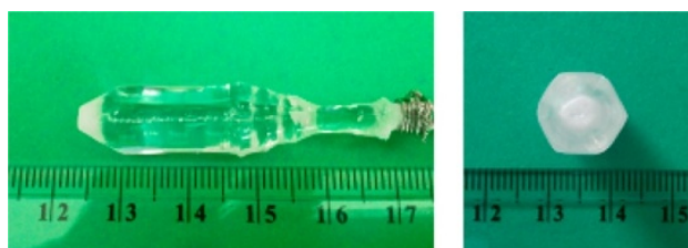
Figura 2.7. Cristal de LGSB crescut în lungul axei c , folosind montajul din Figura 2.1c. În stânga este prezentată imaginea din lateral iar în dreapta imaginea de sus a cristalului.
