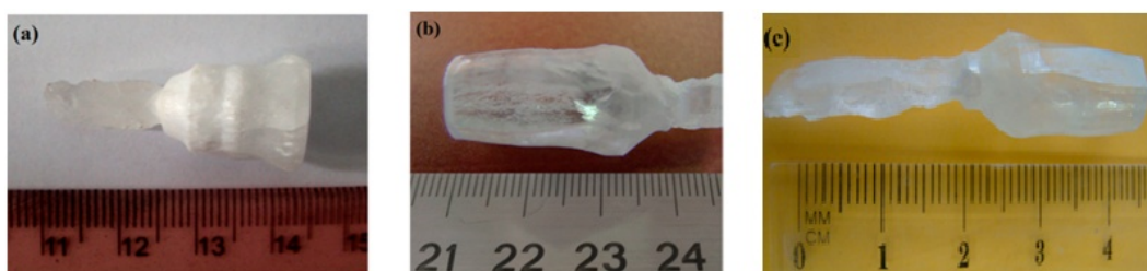
Figura 2.5. Cristale LGSB crescute folosind montajul termic prezentat în Figura 2.1a, pornind de la următoarele compoziții ale topiturii: (a) \text{La}_{0.5}\text{Gd}_{0.6}\text{Sc}_{2.9}(\text{BO}_3)_4 , (b) \text{La}_{0.625}\text{Gd}_{0.625}\text{Sc}_{2.75}(\text{BO}_3)_4 și (c) \text{La}_{0.75}\text{Gd}_{0.5}\text{Sc}_{2.75}(\text{BO}_3)_4 .
