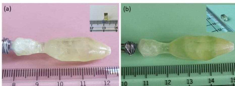
Figura 14. Cristale Pr:LGSB crescute din compozițiile inițiale ale topiturii \text{La}_{0.656}\text{Pr}_{0.022}\text{Gd}_{0.572}\text{Sc}_{2.75}(\text{BO}_3)_4 (a) și \text{La}_{0.651}\text{Pr}_{0.027}\text{Gd}_{0.572}\text{Sc}_{2.75}(\text{BO}_3)_4 (b). Figurile din medalioane prezintă elemente laser decupate din fiecare cristal.
